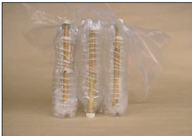
Des bouteilles en plastique rigidifiées verticalement par des tiges de bambou représentent une alternative d'allégement avantageuse utilisable dans les dalles en béton.
